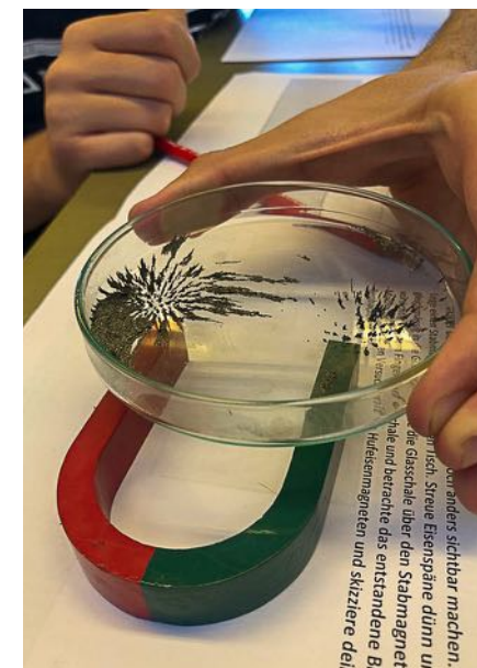
Durch die Verteilung der Eisenspäne wird das magnetische Feld sichtbar gemacht.
